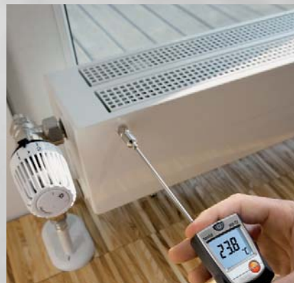
Измерения поверхностной температуры радиатора
