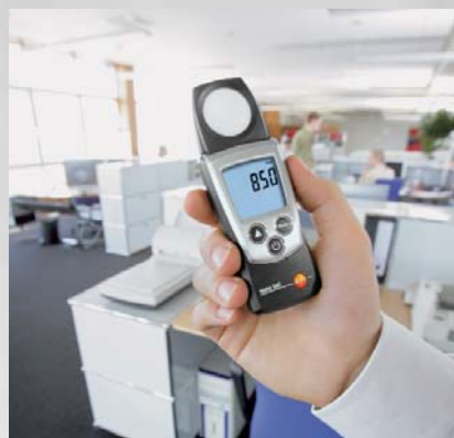
Измерение интенсивности освещенности на рабочих местах
